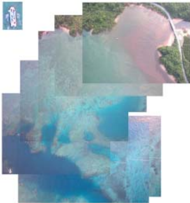
図 16 気球に搭載したニコン製クールピクス5000とワイドコンバーターで撮影した上空300mの合成画像と係留母船の拡大画像
