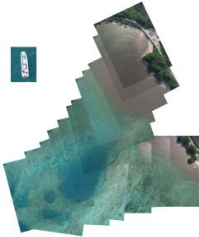
図 15 気球に搭載したミノルタ製 DiMAGE7で撮影した上空 300m の合成画像と係留母船の拡大画像
