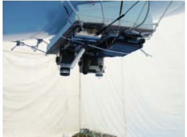
b 小型無人飛行船の腹部に取り付けたデジタルカメラ、ビデオカメラとテレメータシステム
