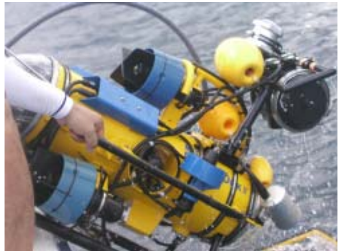
図6 耐圧カメラ容器（写真右上の黒い円筒形容器）を取り付けた改良型水中走行ビデオシステム
